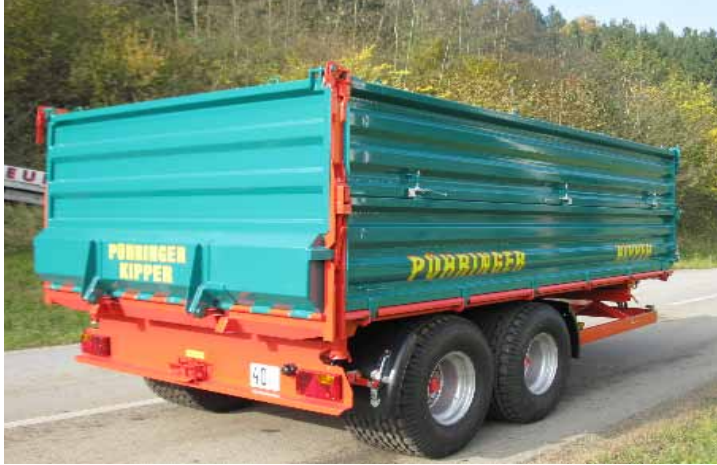
Type 5024 T mit hydr. Heckklappe und Unterfahrerschutz
