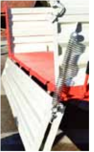
Abklappreinrichtung mit Bordwandhebefebern
