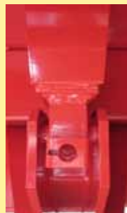
große Kugel u. konische Kugelpfanne mit Überkreuzungssicherung
