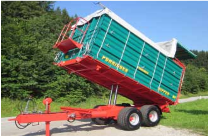
Type 5024 T mit hydr. Heckklappe und Unterfahrerschutz
