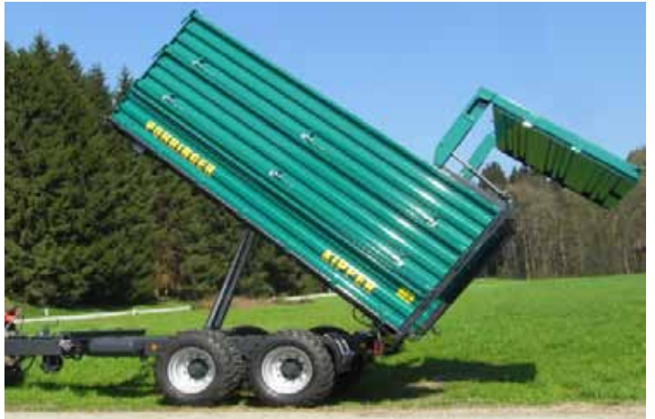
Type 5225 T 40km/h mit seitlichem Unterfahrerschutz
