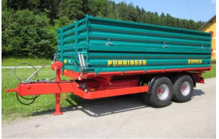
Type 5225 T 40km/h mit seitlichem Unterfahrerschutz
