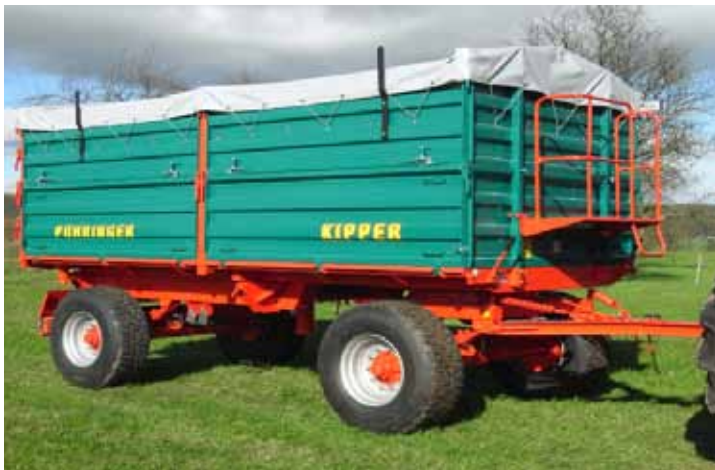
Type 5225 2-A mit geteilten Bordwänden
