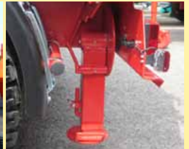
verstellbar und schwenkbare Stützen am Fahrzeugheck
