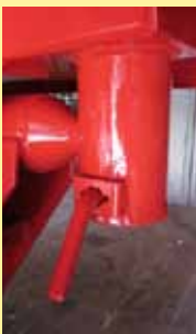
große Kugel u. konische Kugelpfanne mit Überkreuzungssicherung
