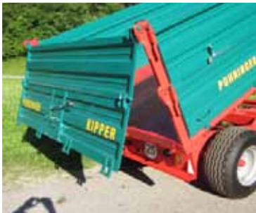
verschiedenste Möglichkeiten zum Öffnen der Grund- und Aufsatzbordwände
