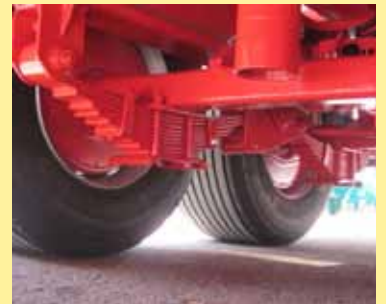
Tandemaggregat mit tiefer gelegtem Fahrwerk, Achsen oberliegend
