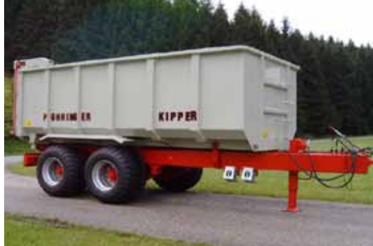
Type 4823 MT Steinmulde aus Hardox
