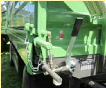
Zentralverriegelung mit selbstentriegelnder Rübenrutsche
