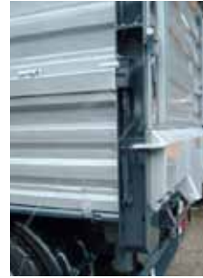
LKW Verschluss- mit verstärktem Ecksteher
