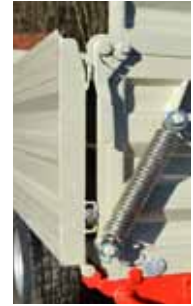
Abklappreinrichtung mit Bordwandhebefebern
