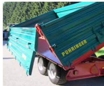
verschiedenste Möglichkeiten zum Öffnen der Grund- und Aufsatzbordwände
