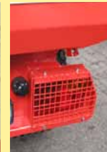
Beleuchtungsschutz mit Gitter
