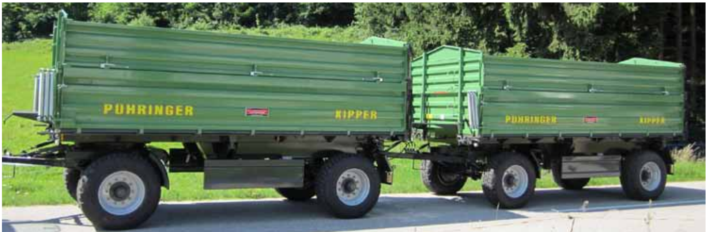
Type 5225 2-A mit geteilten Bordwänden
