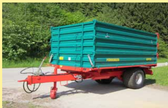
Type 4020 mit geschl. Profilrahmen
